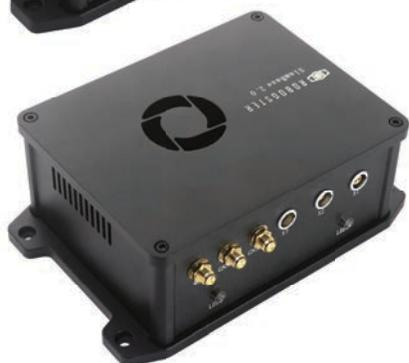
SLAMBasePro采用nVidia的OrinNX平台，内部集成双天线差分GNSS模块、3轴陀螺、3轴MEMS加速度计、3轴磁强计以及气压计，内部传感器采样与1PPS同步，同时将GNSS的1PPS作为输入，可以根据用户配置的频率，生成并输出与1PPS同步的最多4路同步信号，用来给用户的其他传感器提供触发信号，内部传感器数据均采用ROS节点方式输出，所有数据接口均采用带锁扣连接器，是SLAM及三维重建研究的理想平台。
