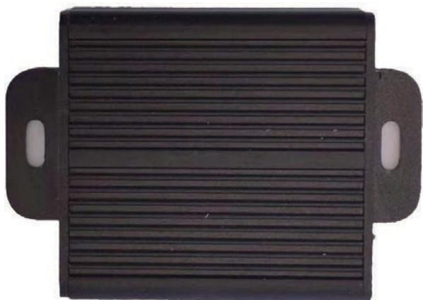
RS-TS5可基于外部1PPS或者内部时钟，实现8通道的同步触发信号生成。8个通道之间、8个通道与外部1PPS之间的同步精度达到微秒级，当外部1PPS无效时，可自动切换为外部基准。8个通道参数可通过串口单独配置，配置参数包括输出频率、输出占空比和输出有效电平。
