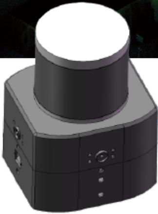
SLAM Plus 是一款高度集成的高性能感知设备，融合了先进的传感器技术和时间同步机制。该设备内部集成四目环视相机、激光雷达、双天线差分GNSS模块、3轴陀螺、3轴MEMS加速度计、3轴磁强计以及气压计，内部传感器采样严格与1PPS (Pulse Per Second) 同步，所有传感器数据采用ROS节点方式输出，所有数据接口均采用带锁扣连接器，更适合移动载体。SLAM Plus为多传感器融合、SLAM、测绘三维建模及全源融合导航研究者提供了一个强大且即插即用的解决方案，是当今领先的感知测量和全源融合导航开发平台。
