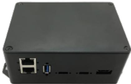
SLAM Base 采用高性能ARM多核处理器，内部集成双天线差分GNSS模块、3轴陀螺、3轴MEMS加速度计、3轴磁强计以及气压计，内部传感器采样与1PPS同步，同时将GNSS的1PPS作为输入，可以根据用户配置的频率，生成并输出与1PPS同步的最多4路同步信号，用来给用户的其他传感器提供触发信号，是SLAM及三维重建研究的理想平台。
